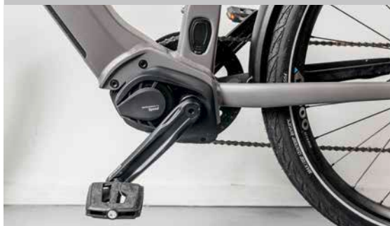
Baricentro centrale grazie al motore centrale
