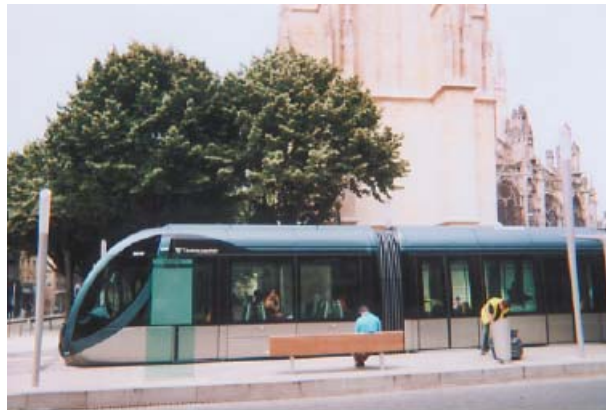
Tram alimentato dal suolo (senza cavi aerei) a Bordeaux Fonte: www.wikipedia.org
